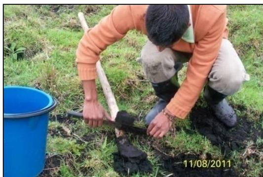
Ilustración 7 - Toma de muestras de suelo para análisis fisicoquímico
