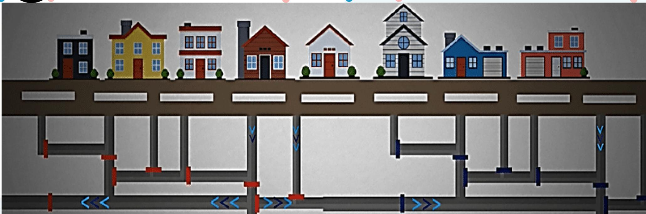
Un sistema de alcantarillado está compuesto por tuberías de RECOLECCIÓN que son las encargadas de recolectar y evacuar las aguas residuales de las viviendas a través de unas TUBERÍAS DOMICILIARIAS que conducen las aguas servidas a unas estructuras de transporte, llamadas COLECTORES. Estas aguas recorren la ciudad y transportan más aguas residuales consigo, son recogidas por lo que conocemos como INTERCEPTORES, que finalmente entregan a un EMISOR FINAL.
