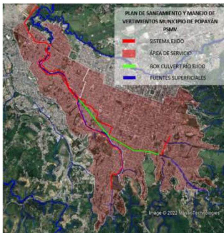
Figura No. 9 Sistema de recolección de aguas servidas para la descontaminación del río Ejido en operación.
