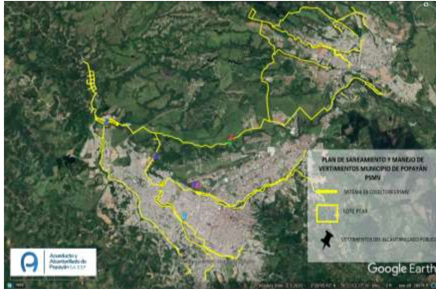
Figura No. 10. Localización puntos de descarga del alcantarillado público de la ciudad de Popayán
